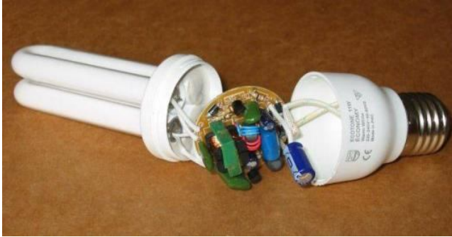
Рис. 10. Встроенный балласт компактной люминесцентной лампы
